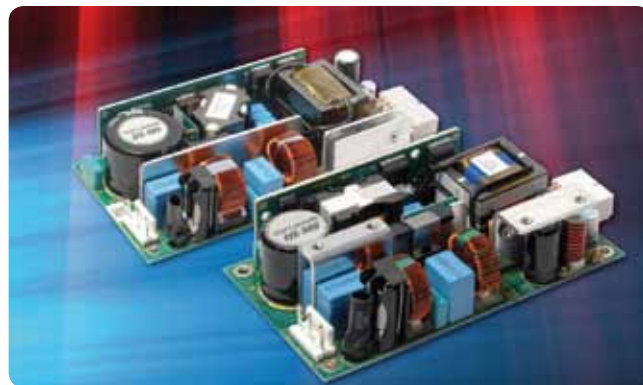
Obr. 4 Prepínateľné napájacie zdroje spoločnosti TDK Lambda s označením EFE majú výstupný výkon v rozsahu 300 až 400 W. Všetky jednotky disponujú kompenzátorom účinníka s typickou hodnotou účinníka 0,97 (splňa normu EN61000-3-2). Bežná účinnosť je 90 %.
